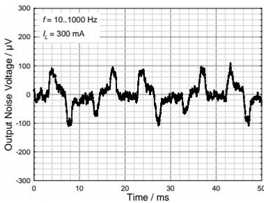
Abb. 11. Ausgangswelligkeit und Rauschen beider Ausgangsspannungen mit Vollast.
