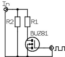
Abb. 18. Messschaltung zur Ermittlung der transienten Lastregelung.
