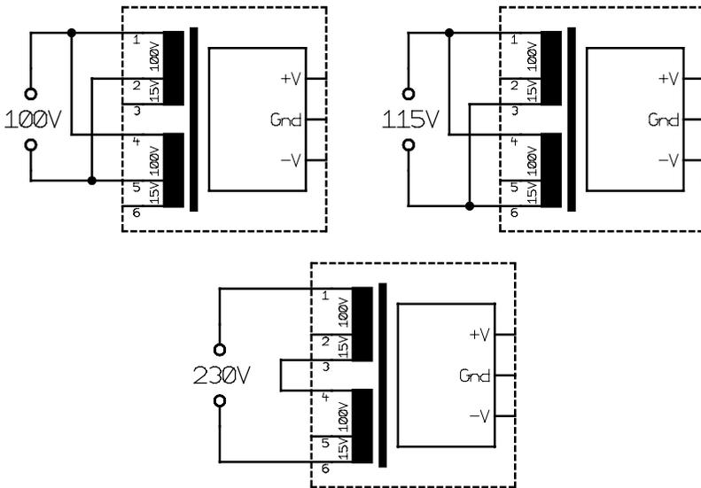
Abb. 1. Anschluss der Netzspannung an die Module der Reihe OF-PSU-B.
