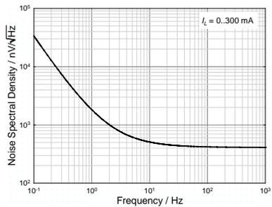
Abb. 12. Frequenzspektrum des Ausgangsrauschens.
