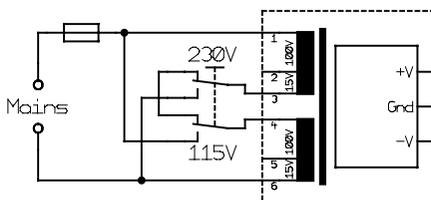
Abb. 20. Umschaltung des Nennwertes der Netzspannung zwischen 115 V und 230 V (USA/Europa) mit einem Spannungswahl-schalter.
