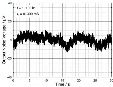
Abb. 9. Niederfrequenz-Rauschen der positiven Ausgangsspannung.
