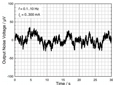
Abb. 8. Niederfrequenz-Rauschen und Drift der negativen Ausgangsspannung.
