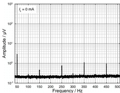
Abb. 3. Restwelligkeit der positiven Ausgangsspannung ohne Last.
