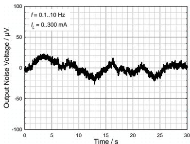
Abb. 7. Niederfrequenz-Rauschen und Drift der positiven Ausgangsspannung.
