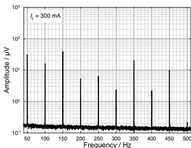
Abb. 5. Restwelligkeit der positiven Ausgangsspannung mit Volllast.
