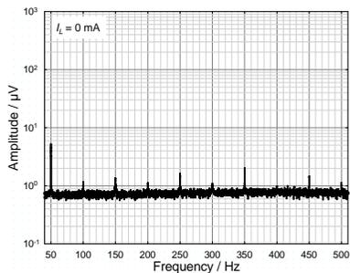
Abb. 4. Restwelligkeit der negativen Ausgangsspannung ohne Last.
