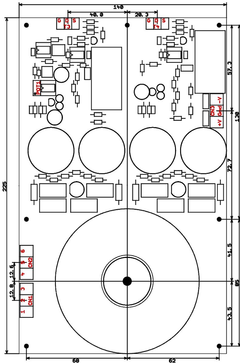
Abb. 2. Anschlüsse und Abmessungen der Module der Reihe OF-PSU-B.
