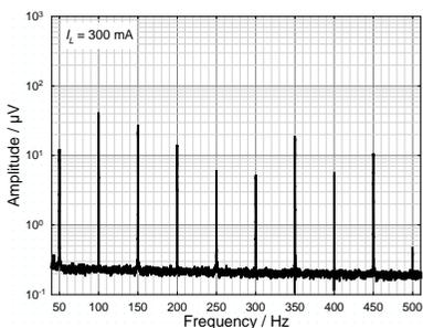
Abb. 6. Restwelligkeit der negativen Ausgangsspannung mit Volllast.
