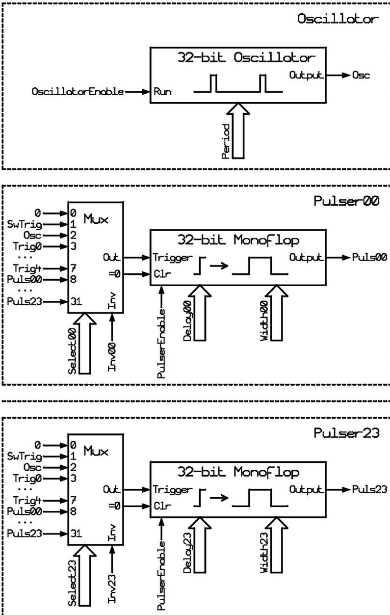
Fig. 1. Pulser Block Diagram.
